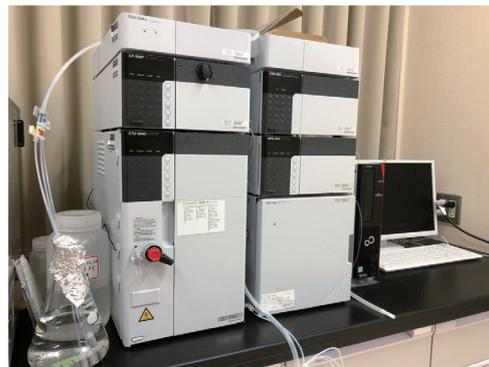
図1. 分析用高速液体クロマトグラフ (HPLC)
