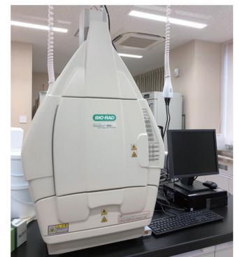
図2. 電気泳動ゲル、メンブレン撮影装置
